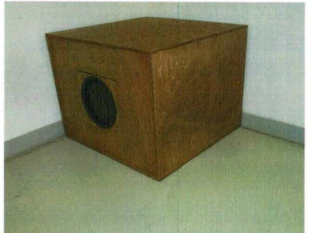
**Bild 2:** Prüfanordnung im Hallraum (1 Helmholtz-Resonator je Hallraumecke)
