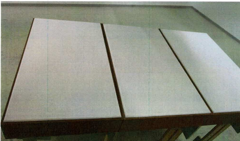
Bild 2: Prüfanordnung im Hallraum
